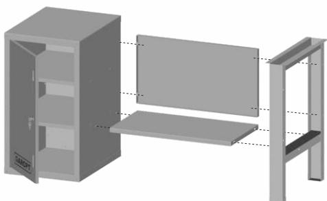
Соберите основание верстака. Для этого соедините полку и стенку с опорой и/или тумбой с помощью 8 винтов М6.
